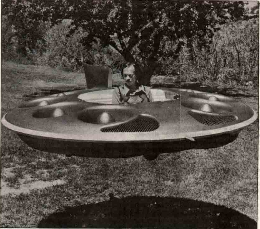
Alfred Moller ve uçan dairesi XM-4. Resimde pervanelerin yerleştirildiği dairesel delikler belirgin olarak görülmekte. Izgaralı bölümler yardımıyla Wankel motorları için gerekli hava sağlanıyor.
