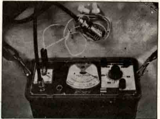
Rezonans yöntemi ile çalışan bir ultrasonik kalınlık ölçer.
